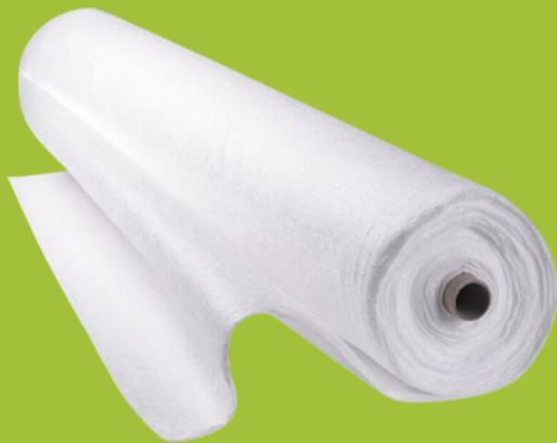
**Description :** Les géotextiles non-tissés de la gamme G, proposés par Juta a. s. sont fabriqués à partir de fibres de polypropylène discontinues, en utilisant la technologie d'aiguillement. Afin d'améliorer les caractéristiques mécaniques et physiques du produit les fibres sont modifiées par calandrage.
