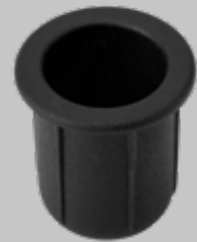
Onyx 20 Sleeve (237A) Alluminium - Noir 35 x 31 mm (H x Ø ) Trou de forage 25 mm
